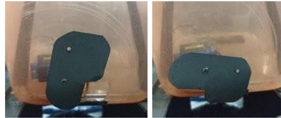
Gambar 9. Hasil pengujian pada motor servo pada kondisi tertutup dan kondisi terbuka.
