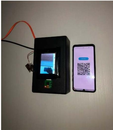
Gambar 8. Gambar *prototype* dan aplikasi *Quick Response (QR) Code* pada *smart key*
